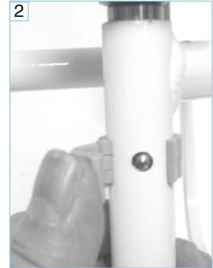
Breng het voorgemonteerde ruggedeelte aan op het basisframe en draai het met de sterschroeven tegen de klok in stevig vast. (afb. 3). Klem de zitting op het frame zoals weergegeven in de afbeelding.
