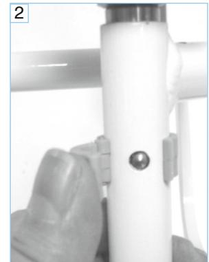
Placez l'élément du dossier prémonté sur le châssis et fixez-le en tournant les vis à poignée étoile dans le sens des aiguilles d'une montre. (fig. 3).
