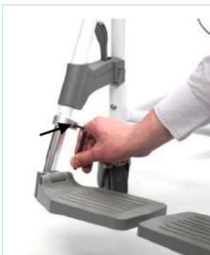
U kunt de hoogte van de voetsteunen verstellen door eerst de klemmschroef los te draaien. Na de verschuiving kunnen de voetsteunen in hoogte worden veresteld. Draai de klemmschroef daarna weer vast.
